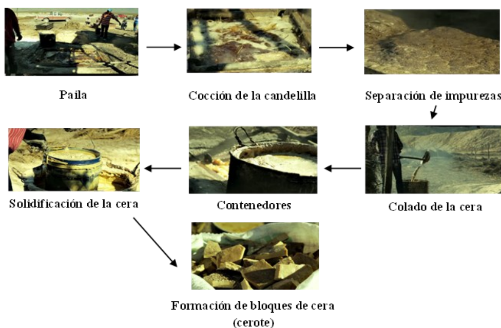
Figura 2. Técnica y proceso de extracción de cera de candelilla (Fotografías del autor de correspondencia).
